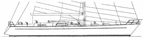
Bei einer Masthöhe von 26 m, einer Segelfläche von 220 m<sup>2</sup> und einem Spiner von 351 m<sup>2</sup> gleitet das Schiff mit einer mittleren Geschwindigkeit von 9.5 kn.
